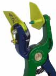
6. Zange fertig zum Einziehen
